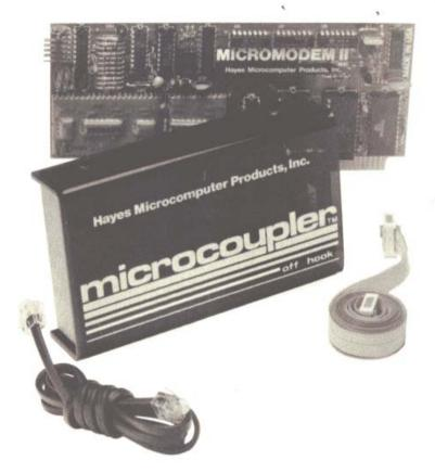
INSTALLING THE MICRO-MODEM II PRINTED CIRCUIT BOARD BE SURE THE COMPUTER IS TURNED OFF BEFORE BEGINNING INSTALLATION.
